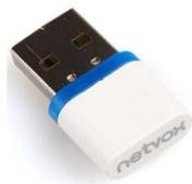
Z108设备在网络中作为路由器（Router）或协调器（Coordinator）使用。Z108提供标准的USB接口，直接从USB取电，方便PC等主设备接入ZigBee Pro™系统。使用第三方软件（如ZiG-BUTLER软件）可通过它进行设备的搜索、加网与控制。
